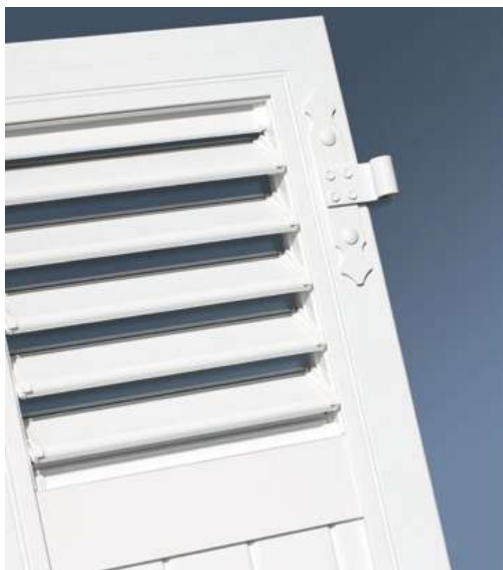
Volet ajouré avec lames extrudées de 47 x 10 Cadre volet de 80 x 33 avec moulure
